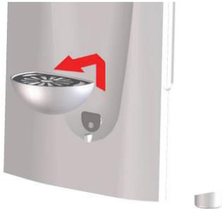
Lavare la vaschetta e la griglia separatamente con acqua tiepida. Asciugare tutti i componenti. Riposizionare la griglia sopra la vaschetta. Inserire la vaschetta nella sua sede e premerla verso il basso per renderla solidale con la macchina.
